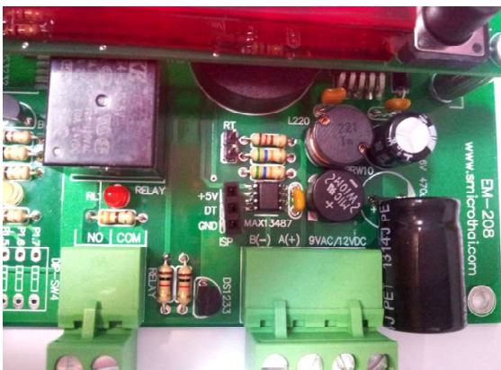
บริเวณขั้วต่อ Supply RS485 และ Relay
