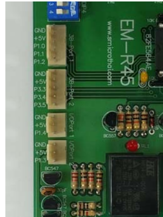
ขั้วต่อเพื่อขยาย Relay และ Input 6-9
