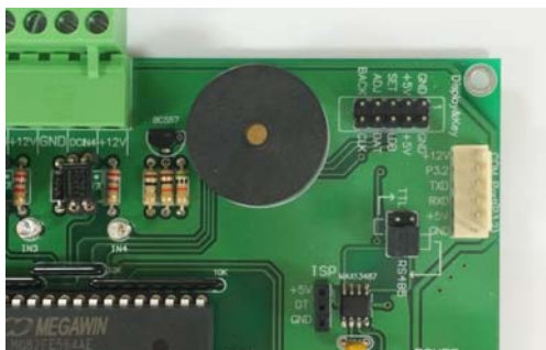
ขั้วต่อ Digital IO และขั้วขยาย Input-5 พร้อมต่อกับ RF Module
