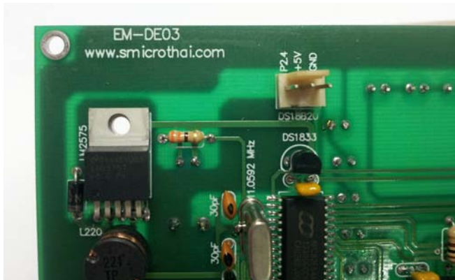
ขั้วต่อหัววัดอุณหภูมิ DS18B20
