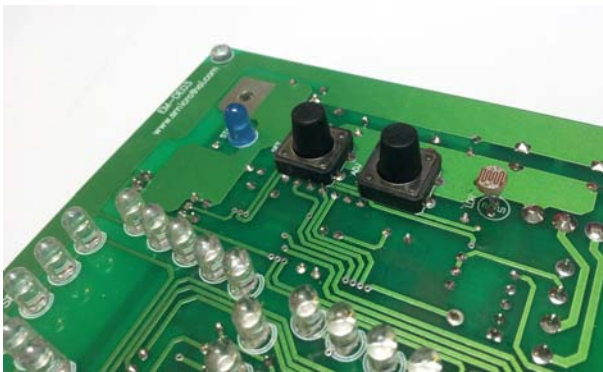
บริเวณปุ่มกด, Alarm-LED และตัวรับแสงภายนอก
