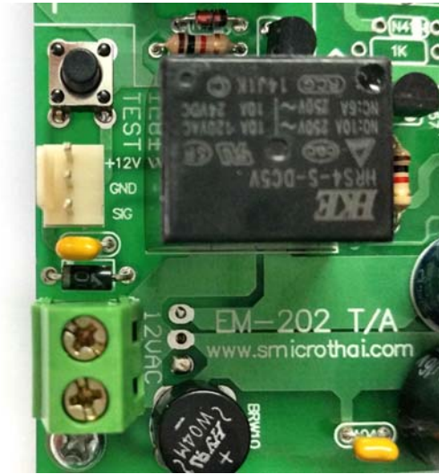
ขั้วต่อกับไฟจากหม้อแปลง และขั้วต่อกับตัวหยุดเหรียญ (มีปุ่ม Test)
