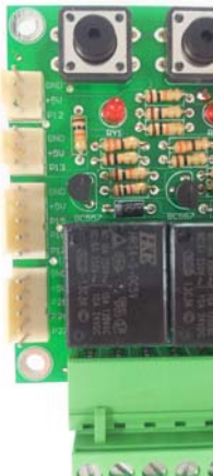
ขั้ว 3.5 Pin เพื่อขยาย Relay และ Key
